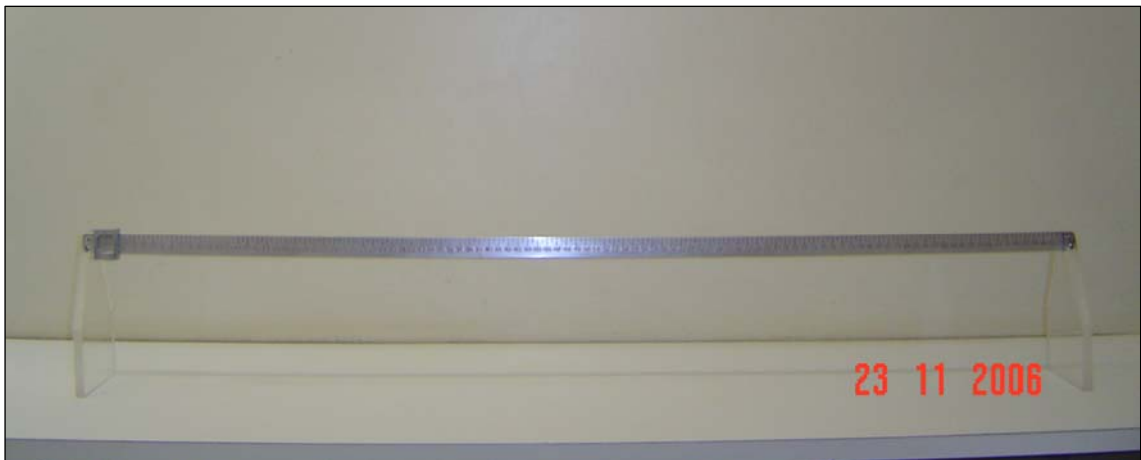
Figura 1: Vista geral da VAS elaborada para o estudo, tendo a mesma um metro de extensão representado pela régua metálica, apoiada em suportes acrílicos laterais.
