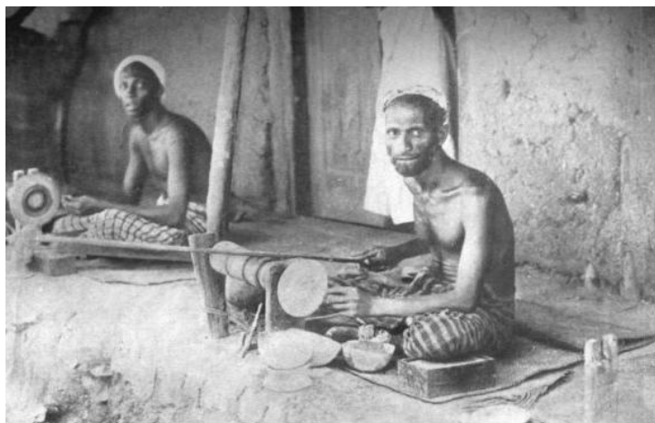
Figura 37 - Lapidação Indiana. Maquinário acionado com força manual. Bow driven (BRUTON. 1978).
