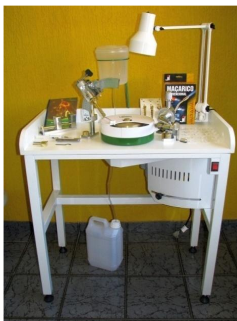
Figura 50 - Kit 3 x 1 Lapidart , facetador, calibrador, encanetador / transferidor, juntamente com bancada e acessórios. Atualmente possui o valor de R$ 8.500,00 (ASPAHAN, 2009).
