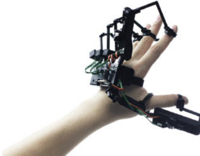
Figura 3.10 O dispositivo Dexta Robotics Dexmo F2 fornece rastreamento de dedo e feedback de força. (Cortesia de Dexta Robotics)
