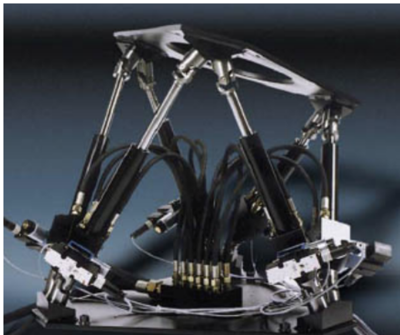
Figura 3.13 Uma plataforma ativa de movimento controlada por atuadores hidráulicos. Uma cadeira pode ser anexada ao topo da plataforma. (Cortesia de Shifz, Associação de Arte Sintarturalista)
