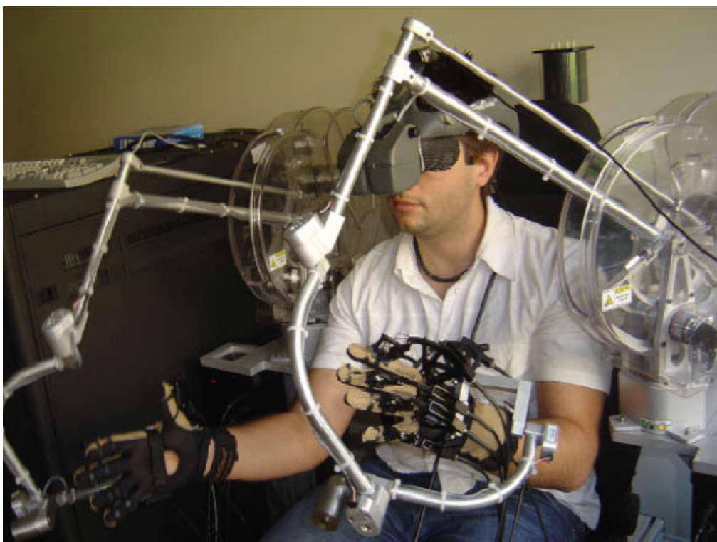
Figura 3.12 Estação de Trabalho Imersiva Cyberforce da Cyberglove. (Cortesia de Haptic Workstation com HMD da VRLab na EPFL, Lausanne, 2005)
