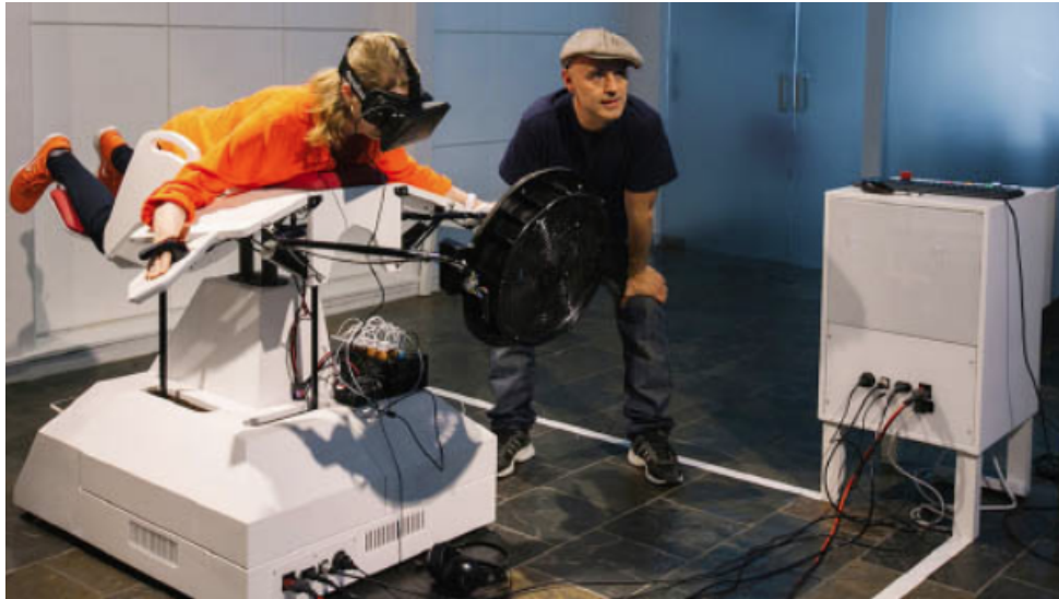
Figura 3.14 Birdly, por Somniacs. Além de fornecer estímulos visuais, auditivos e de movimento, essa experiência de RV proporciona uma sensação de paladar e olfato. (Cortesia de Swissnex San Francisco e Myleen Hollero)
